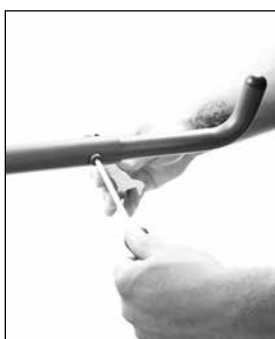
13. Gebruik een inbussleutel en een 13 mm moersleutel en verwijder de moer en sluitring. Plaats in de gewenste positie. Gebruik een inbussleutel en een 13 mm moersleutel en draai ze stevig vast. Plaats de zwarte beschermkap op de moer.
