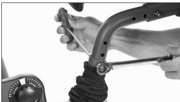
9. Gebruik een inbussleutel en een 13 mm sleutel om stevig vast te draaien.
